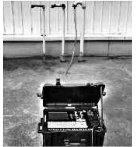
한전 전력연구원이 남부발전 하동화력 5호기에서 시험 및 실증했던 '발전기 권선 수소누설량 연속 측정기'의 모습.
